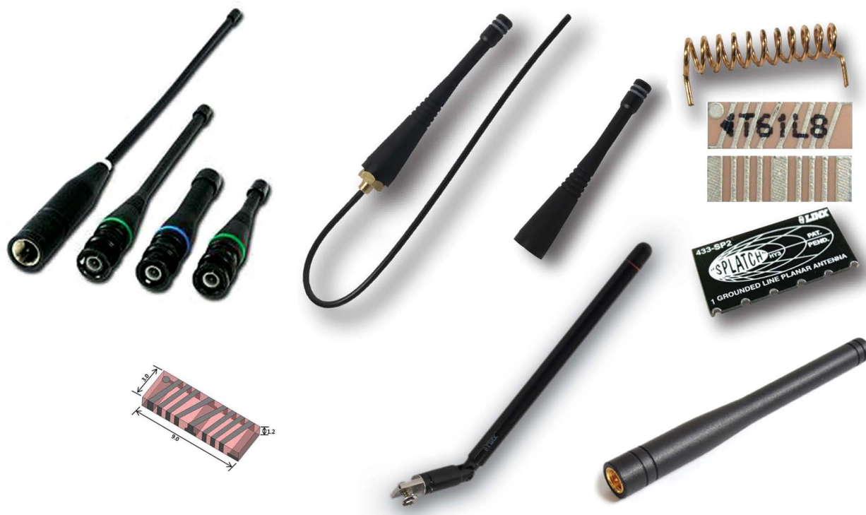
Рис. 5. Полноразмерные и миниатюрные антенны
